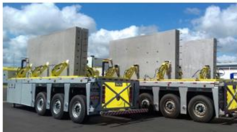
Figura 10 - Transporte de painéis em carretas especiais do tipo In Loader.
