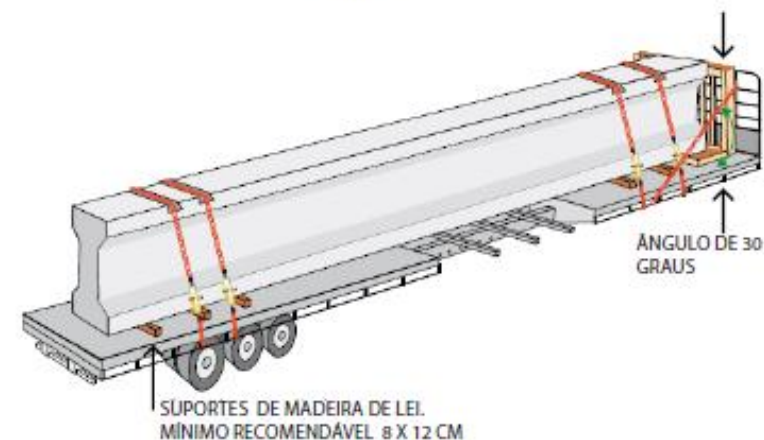
ESTRUTURA DE PROTEÇÃO DIANTEIRA, COM FIXAÇÃO A 2/3 DA ALTURA
